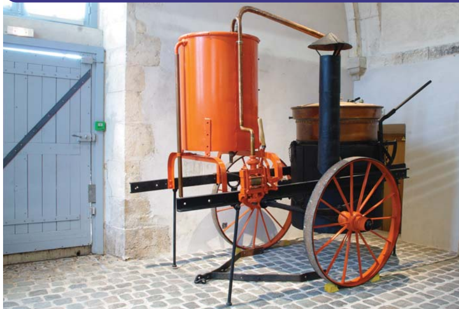
DEROY fils aîné (Paris), Alambic, capacité 550 litres, métal, fonte, peinture, Vers 1890, coll. Association « La Fraternelle » de Bou, © MML
