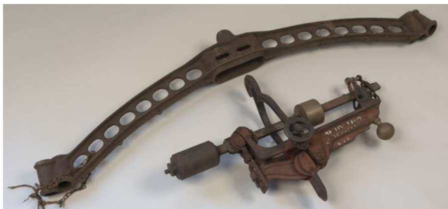
Marlin (fabricant), balance romaine à support de pesée (sans les pieds), alliage métallique, Inv. 2013.0.25, coll. et © MML
